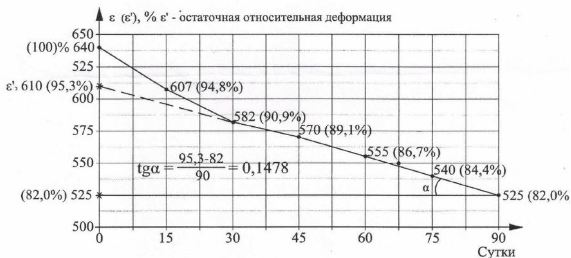
Рис. 1. Изменение относительной (остаточной относительной) деформации материала "CONIPUR® М 800" при термостарении в лабораторных условиях
